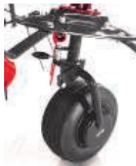
Die Laufräder können für das Grenzstreuen und für den Streuwinkel eingestellt werden (400I4 ALP, 600I6 ALP).
